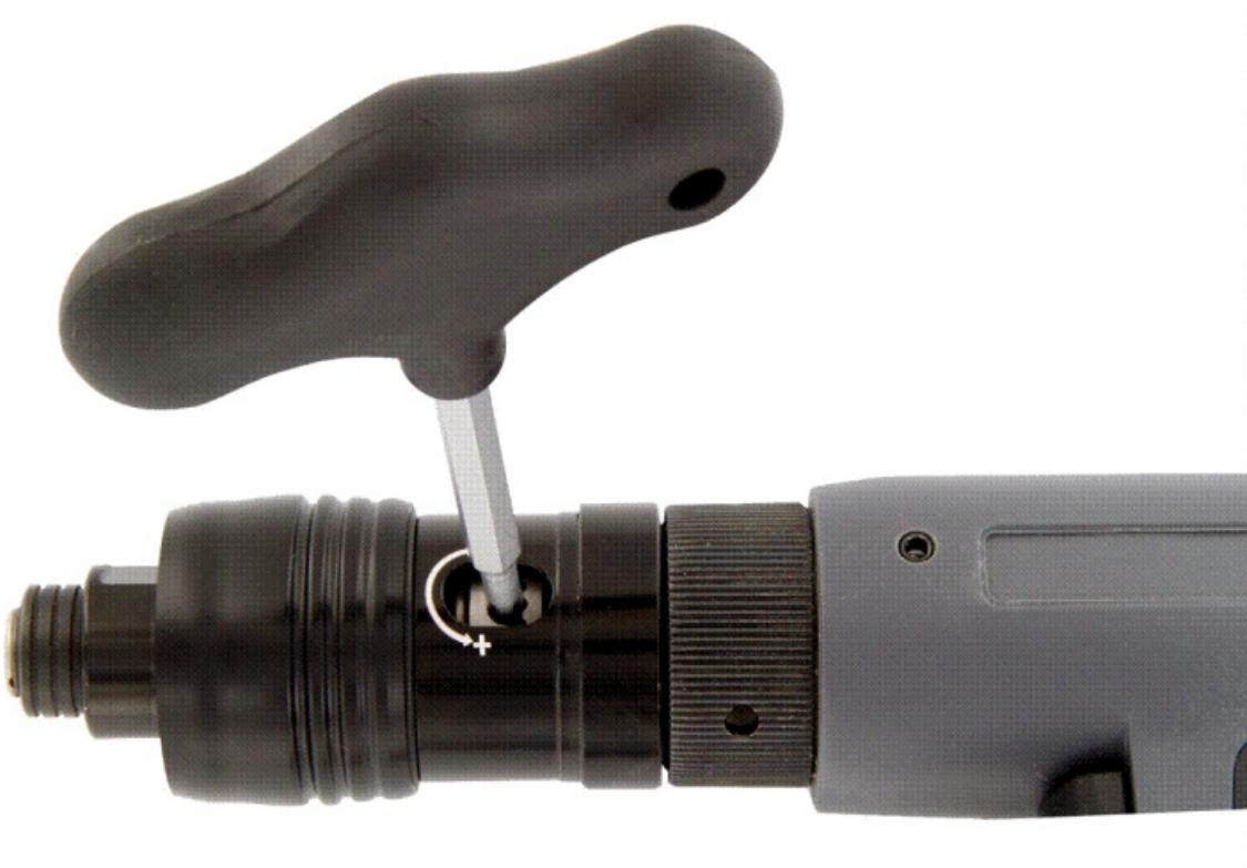
Zasuňte nastavovací klúč do otvoru.
