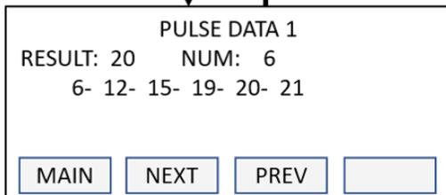
Ergebnis: 20 = Der Durchschnittswert, bei dem der Impulsschrauber abgeschaltet wird.
