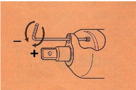
Das Öl der Impulseinheit muss regelmäßig erneuert werden. Wenn kein vorbeugende Ölwechsel gemacht wird kann dies zu einem niedriger Drehmoment führen weil die Viskosität des Öls sich ändert und es können Schaden an die interne Teile der Impulseinheit entstehen.
