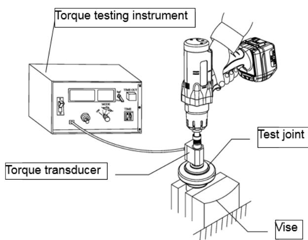
Test 3: misura dinamica con un trasduttore rotativo sull'applicazione reale.
