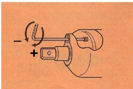
Olien i pulsenheden skal skiftes regelmæssigt. Forebyggende vedligeholdelse er vigtig, fordi hvis olien skiftes for sent, ændres viskositeten, så momentet falder, og der kan opstå skader på de indre dele.
