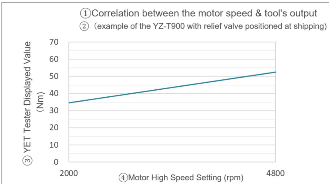
Lo anterior muestra la influencia de la velocidad del motor en la salida del par. Este es un ejemplo de la YZ-T900 probado en el probador de par estático YET-1001C.
