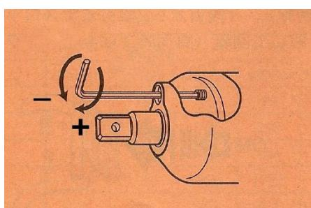
Olej v impulznej jednotke sa musí pravidelne vymieňať. Ked' sa preventívna výmena oleja nevykoná, z dôvodu zmeny viskozity oleja to môže viesť k poklesu nastaveného krútiaceho momentu a poškodzuje to aj vnútorné časti impulznej jednotky.
