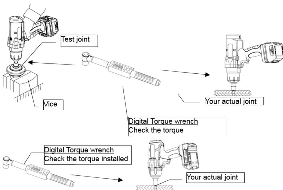
Méthode de test 2 : mesure dynamique avec transducteur de couple rotatif sur joint test.
