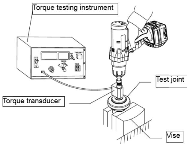
Testovacia metóda 3: dynamické meranie pomocou rotačného snímača úťahovacieho momentu v reálnej aplikácii.
