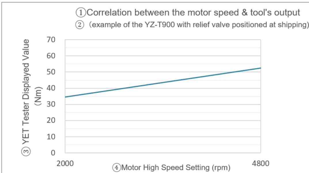
Quanto sopra mostra l'influsso della velocità del motore sul rendimento della coppia, questo è un esempio del YZ-T900 testato sul misuratore YET-1001C della coppia statica.
