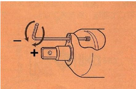
L'huile dans le bloc impulsions doit être remplacée régulièrement. La maintenance préventive est importante parce que si l'huile est remplacée trop tard la viscosité change et ainsi le couple va descendre et des dommages peuvent apparaître dans les pièces internes.
