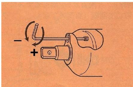
Sostituire periodicamente l'olio nel meccanismo ad impulsi. La manutenzione preventiva è importante per assicurare una coppia stabile ed evitare il danneggiamento delle parti interne.
