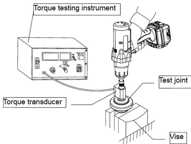
Método de prueba 3: medición dinámica con un transductor de par rotativo en la aplicación real.
