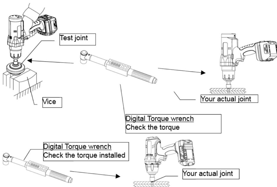
Método de prueba 2: medición dinámica con un transductor de par rotativo en una junta de prueba
