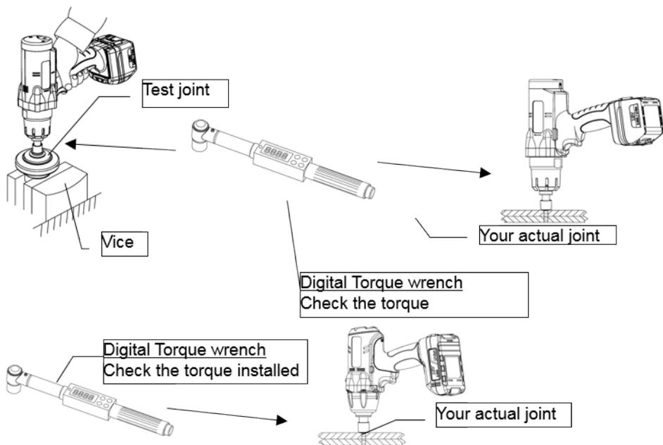
Testmetode 2: dynamisk måling med en drejelig momenttransducer på en testforbindelse.
