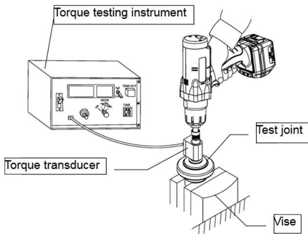
Testmetode 3: dynamisk måling med en drejelig momenttransducer på en faktisk anvendelse.
