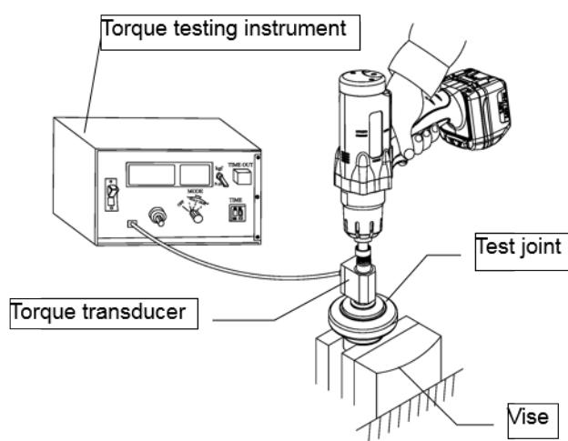
Método de prueba 3: medición dinámica con un transductor de par rotativo en la aplicación real.
